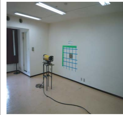
②超音波探査によるコア採取予定位置を X 線撮影し、再度確認を行う。
